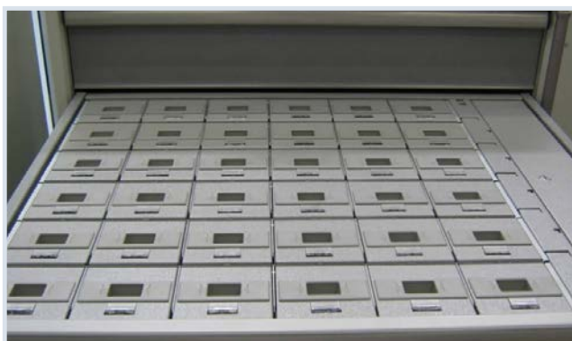
Les couvercles sont contrôlés par la technologie de guidage Pick-to-Light (sélection à la lumière)
